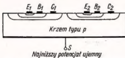
Rys. 2. Struktura zawierająca dwa niezależne tranzystory
