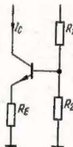
Rys. 5. Podstawowy układ źródła prądowego
